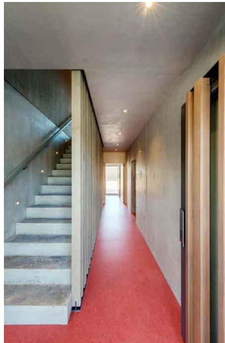
Innern führt eine Sichtbetontreppe vom Erdgeschoss ins erste Obergeschoss, eine Holztreppe vom ersten Obergeschoss ins Dachgeschoss. Die Flure im Treppenhaus sind mit ziegelrotem Linoleum ausgelegt, als Bezug zur gleichfarbigen Kirche gegenüber. Die Wohnräume haben einen Eichen-Naturholzboden. Fenster und Außentüren bestehen aus Holz-Alu-Elementen, die Innentüren sind weißlackierte flächenbündige
